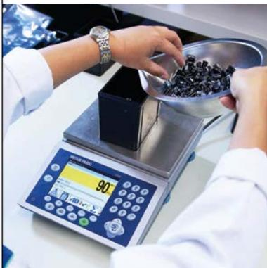
Lorsqu'ils comptent les pièces ou vérifient l'exhaustivité d'un colis à l'aide d'un système de pesage, les opérateurs doivent généralement se concentrer sur l'écran du terminal, ce qui ralentit le processus. La fonction colorWeight® leur indique lorsque le nombre cible est atteint, grâce à un code couleur. Ainsi, l'écran n'accapare pas l'attention de l'opérateur et ce dernier peut effectuer le comptage plus rapidement. Votre entreprise gagne ainsi du temps et de l'argent.
