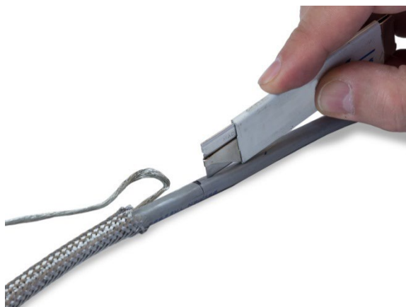
Figure A-34 : Découpe de la gaine du câble
