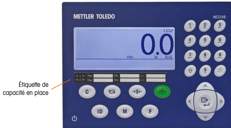
Figure A-75 : Étiquette de capacité installée
