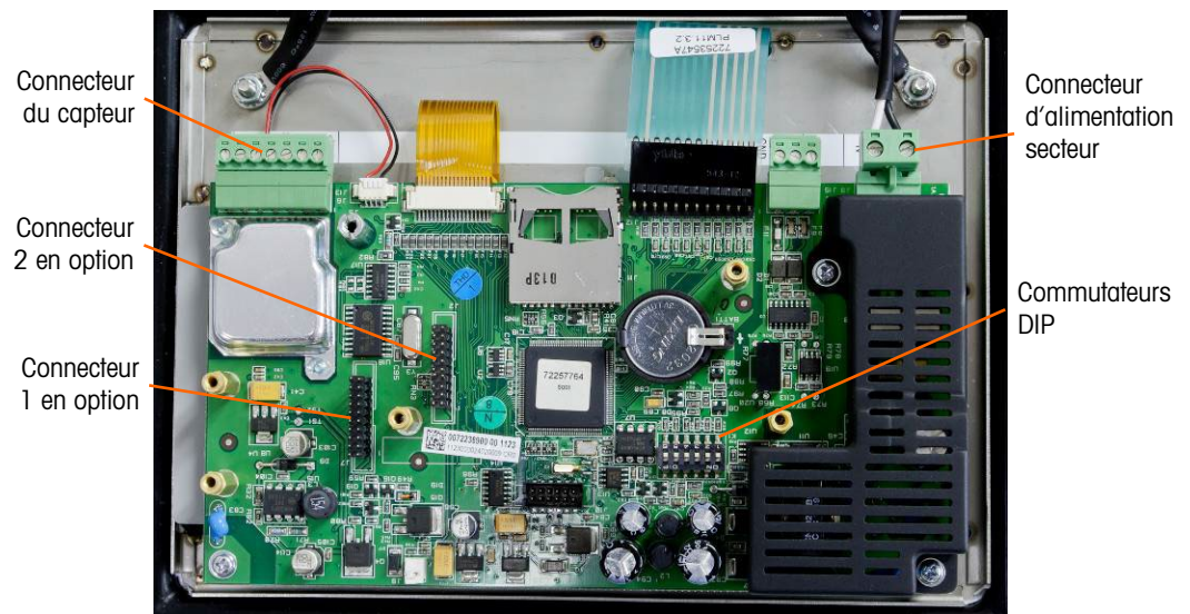
Figure A-19 : Connexions de la carte principale de l'IND246, modèle secteur
