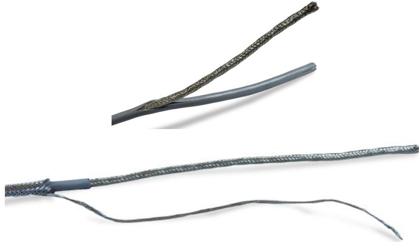
Figure A-35 : Dénudage de la gaine du câble sur le blindage tressé interne
