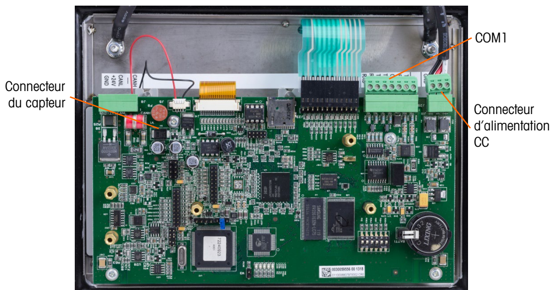
Figure A-21 : Connexions de la carte principale de l'IND246 POWERCELL
