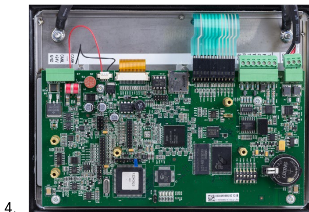
Figure A-71 : Emplacement du bloc de commutateurs 1 sur la carte principale, modèle POWERCELL
