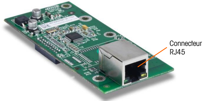
Figure A-60 : Carte en option de connexion Ethernet
