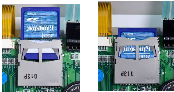
Figure A-73 : Introduction d'une carte SD dans le support SD (à gauche) ; carte SD installée (à droite)
