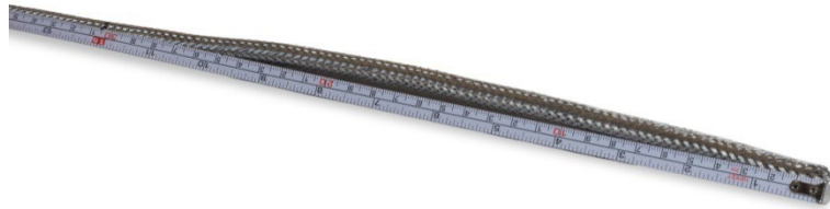
Figure A-29 : Mesure du blindage tressé extérieur avant la coupe
