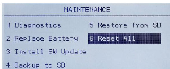
Figure 3-32 : Réinitialisation de tous les blocs de configuration
