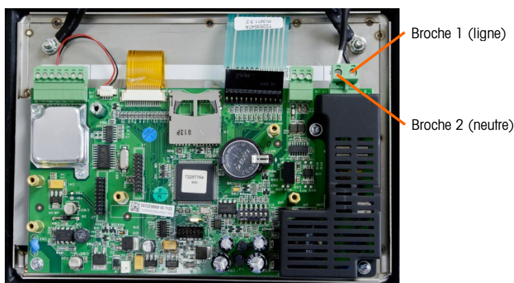
Figure 5-5 : Emplacement des broches pour le test d'alimentation secteur, version analogique
