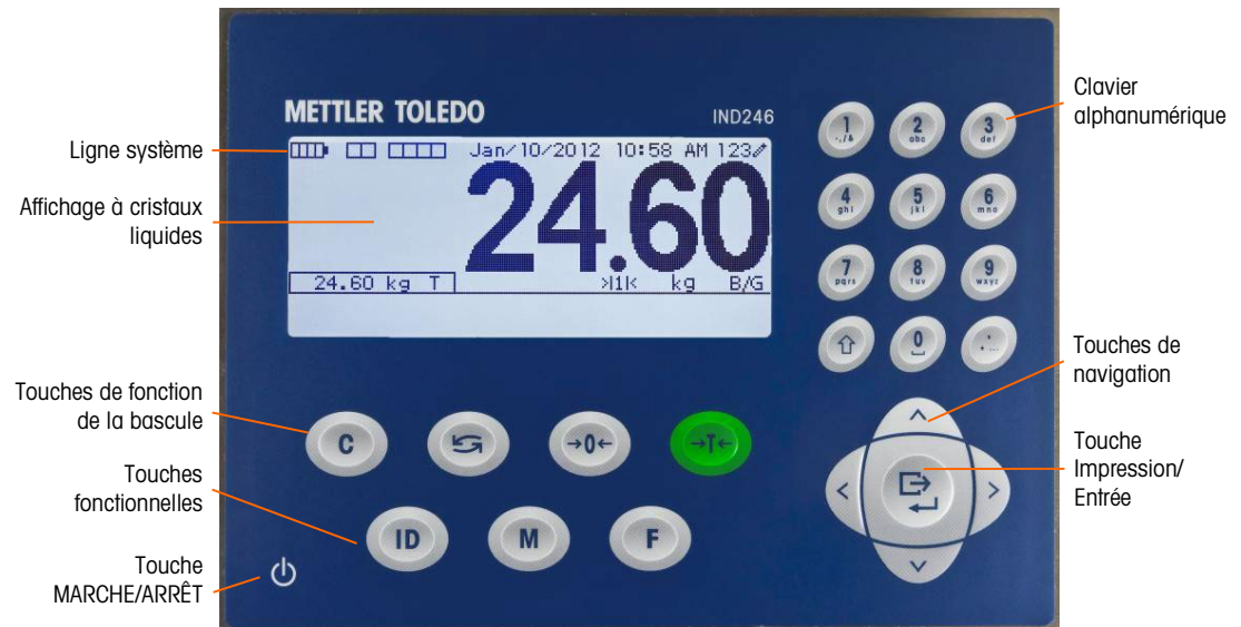
Figure 1-5 : Agencement du panneau avant de l'IND246
