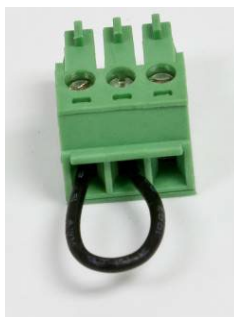
Figure 5-11 : Cavalier entre les bornes de transmission et de réception de COM1
