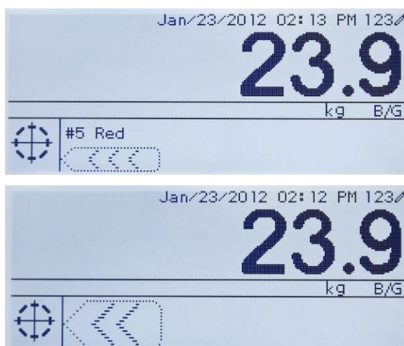
Figure 4-8 : Affichage graphique SmartTrac, zones non activées : Petit (en haut) et grand (en bas)
