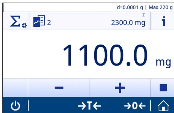
Die Anwendung **Summe** ermöglicht das Wägen verschiedener Proben und das Summieren der Gewichtswerte zu einem Gesamtgewicht.
